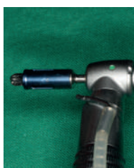
Рис. 7, а-с. Расширение отверстия выполнено путём смены римеров, а продвижение вглубь выполнено со сменой ограничителей.
